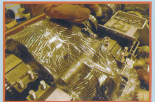
▲ 圖4. 外曝構件隔離保護
