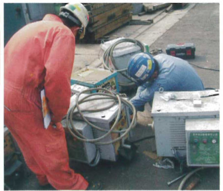
▲電焊機入廠前檢測其自動電擊防止器動作情形
